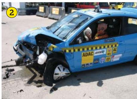
TCS Crashtests zeigen: Autos werden immer sicherer; Bild 1: Produktionsjahr 1987, Bild 2: 2007.
